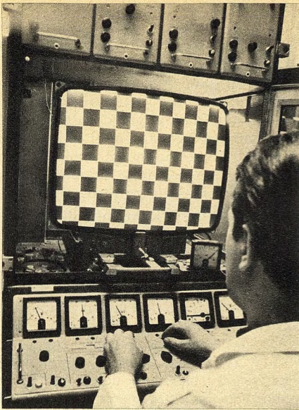
Bild 4. 61-cm-Schwarzweiß-Bildröhre B 61 G 1 mit „Selbond“-Impllosionsschutz auf dem Prüfstand
