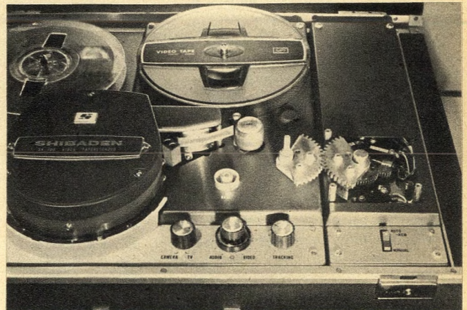
Bild 3. Rechts die angebaute Umschalteinrichtung für den automatischen Bandrücklauf
